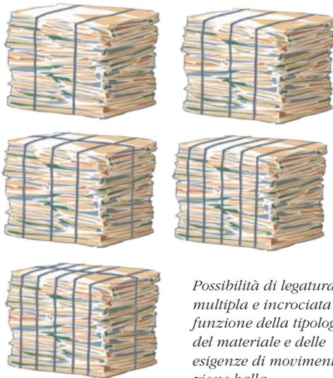
*Possibilità di legatura multipla e incrociata in funzione della tipologia del materiale e delle esigenze di movimentazione balla.*
